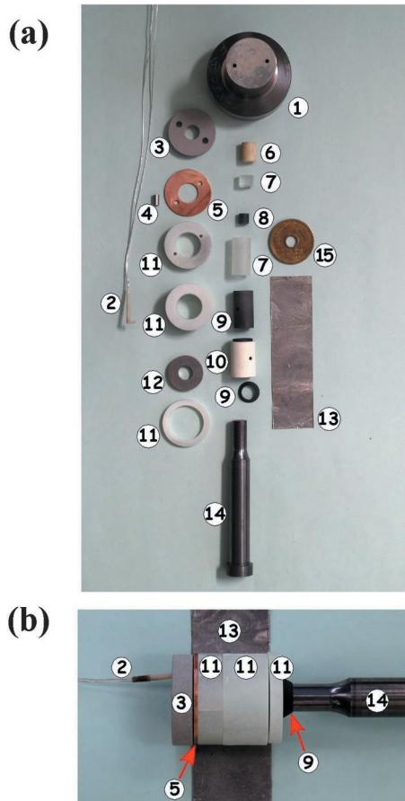
第6図 試料セルを構成するパーツ (a) とシリンダーにセットする前に組み上げた試料セルの写真 (b). 1. 上アンビル, 2. 熱電対, 3. 葉ろう石, 4. ステンレス, 5. 銅, 6.  $\text{Al}_2\text{O}_3$ , 7. ガラス, 8. 試料, 9. グラファイト, 10. ジルコニア, 11. タルク, 12. 鋼, 13. 鉛, 14. インナーピストン, 15. 5円玉. (本特集号の安東他の第2図を参照).
