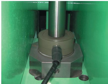
第5図 ロードセルの写真。このロードセルを用いて、インナーピストンに発生する軸荷重を測定する。
